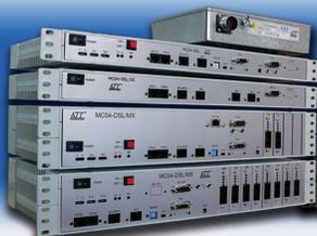
SDH-мультиплексор : 155 Мбит/с (STM-1) терминальный или вставки-выделения до 8 портов Ethernet до 24 портов E1
