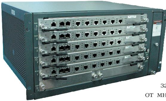
Маршрутизатор Netperformer SDM-9600 производства VERSO Technologies обеспечивает высокую производительность и поддерживает широкий набор протоколов для работы в различных сетях связи, включая TDM-, FR-, IP-, GSM-сети и сети спутниковой связи.
