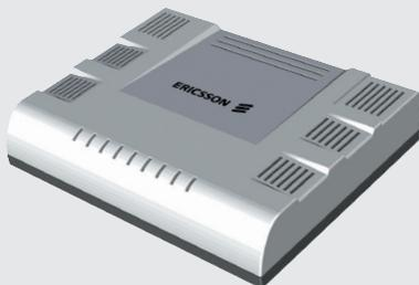
Телефонные порты несут функциональность VoIP-шлюза, работающего по протоколу SIP или H.248 (кодеки G.711, G.723.1, G.726 и G.729). К ним можно подключить не только телефонный аппарат, но и факс-аппарат или модем.
