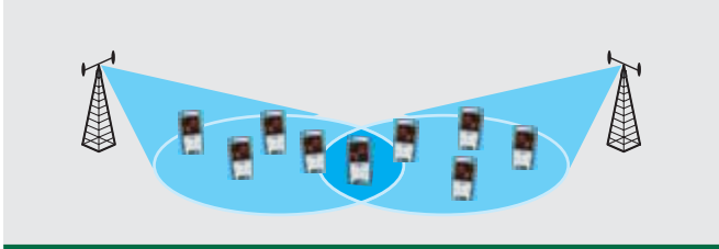
Рис. 3. Телевещание в сотовой сети с помощью MBSFN
