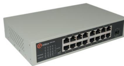
Коммутаторы QTECH QSW-2500 A поддерживают удаленное управление и развитые политики обеспечения качества обслуживания (QoS). Они имеют низкое энергопотребление, интуитивно понятный веб-интерфейс управления, включая возможность экспорта и импорта конфигурации, и кнопку восстановления исходных параметров.
