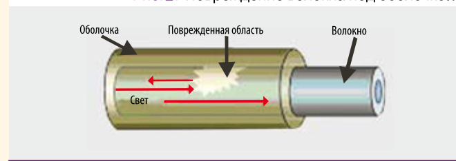
Рис. 2. Повреждение волокна под оболочкой
