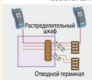
Рис. 4. Применение двух OLTS для проведения паспортизации кабельной сети
