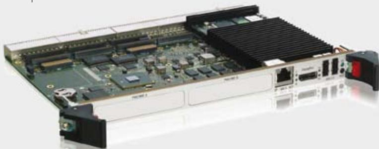
Встроенная память 1066 МГц ECC объемом 8 Гбайт гарантирует целостность данных. В дополнение к гнезду CompactFlash для промышленных флеш-модулей на CP6002 можно установить до 32 Гбайт памяти NAND Flash по интерфейсу SATA.
