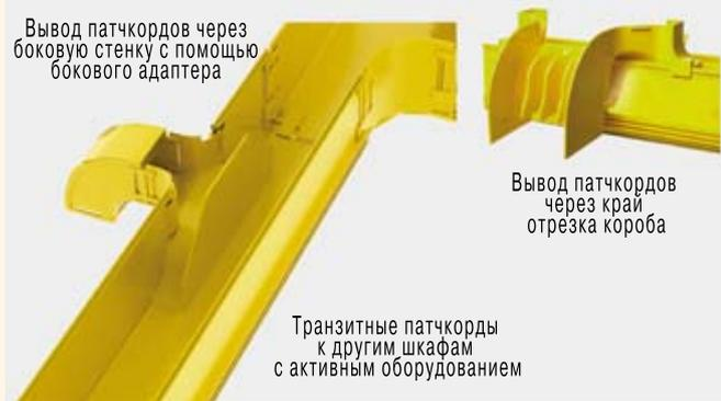
Вариант спуска через боковую стенку позволяет вывести требуемое количество шнуров с одновременным пропуском транзитных патчкордов к другим шкафам в зале. В этом случае пучки выходящих и транзитных патчкордов пространственно разделены, что позволяет наилучшим образом провести их выкладку.
