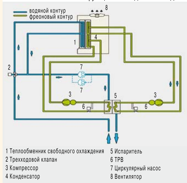
Рис. 2. Принципиальная схема чиллера с функцией свободного охлаждения
