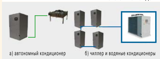
Рис. 1. Наиболее распространенные варианты комплектации системы охлаждения
