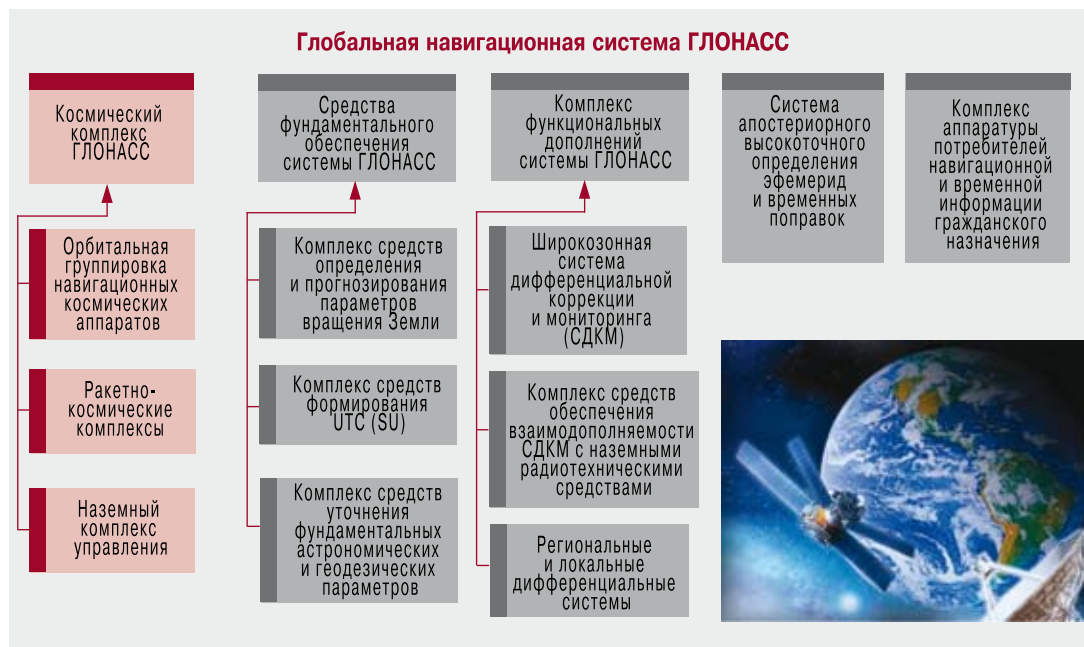
Рис. 1. Состав системы ГЛОНАСС
