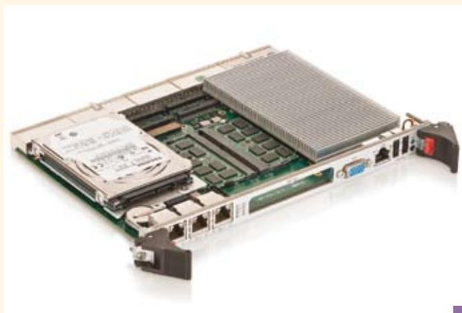
Объем кэш-памяти CP6004-SA – 6 Мбайт, оперативной памяти DDR3 ECC SO-DIMM с частотой 1600 МГц – до 16 Гбайт. Поддерживается технология «горячей» замены и конфигурируемая шина PCI 64-bit/66 МГц или PCI-X.
